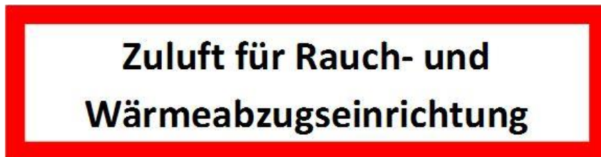
Kennzeichnung von Zuluftöffnungen
